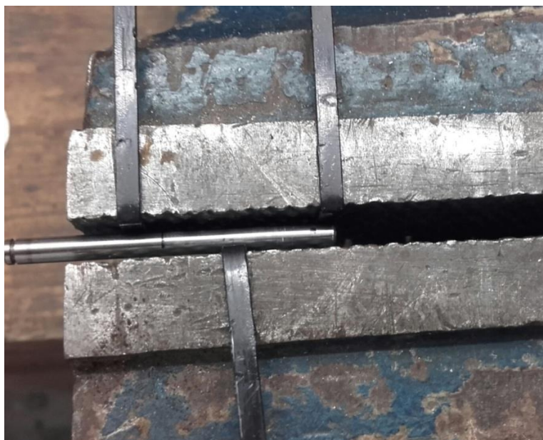
Figura 3 – Aperto num torno de bancada, para desfazer o empeno
