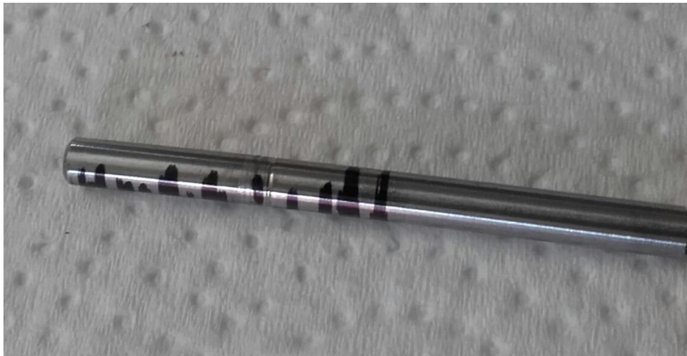
Figura 2 – Marcas indicando a parte saliente do empeno
